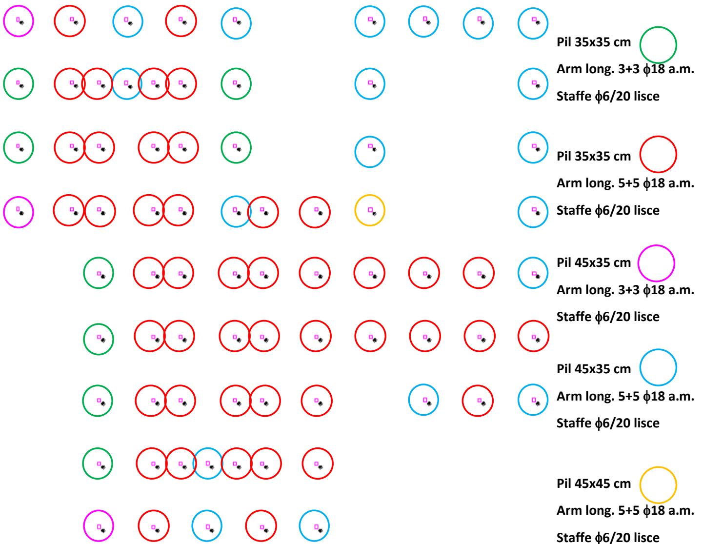
Figura 12 Pianta Livello 1, con indicazione delle tipologie di sezione dei pilastri
